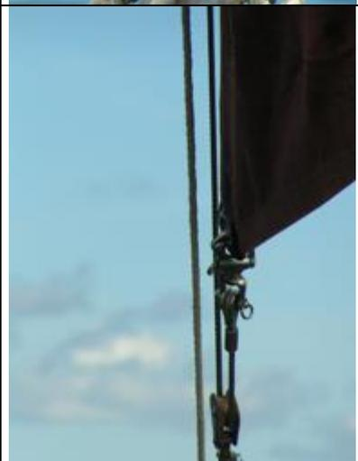
2. Frapper le point de drisse de foc sur le palan de drisse.
