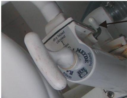
5 - Mettre la manette d'admission d'eau en position ouverte et faire quelques pompages pour ajouter de l'eau dans la cuvette.
